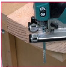
Taglio regolare fino ad uno spessore di 48 mm
